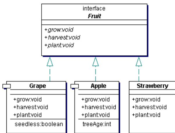
水果介面規定出所有的水果必須實作的介面，包括任何水果類別必須具備的方法：種植 plant()，生長 grow() 以及收穫 harvest()。介面 Fruit 的類別圖如下所示。
