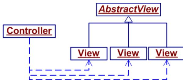
換言之，控制器端可以建構合適的視圖端，就如同工廠角色建構合適的物件角色一樣；而模型端則可以充當這個建構過程的用戶端。
