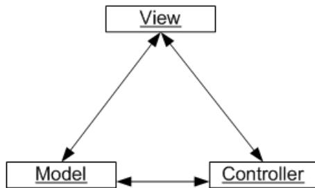
簡單工廠模式所建構的物件往往屬於一個產品層級結構，這個層級結構可以是 MVC 模式中的視圖（View）；而工廠角色本身可以是控制器（Controller）。一個 MVC 模式可以有一個控制器和多個視圖，如下圖所示。
