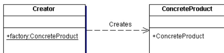
下面是工廠類別的程式碼。顯然，這個類別提供一個工廠方法，傳回一個具體產品類別的實例。
